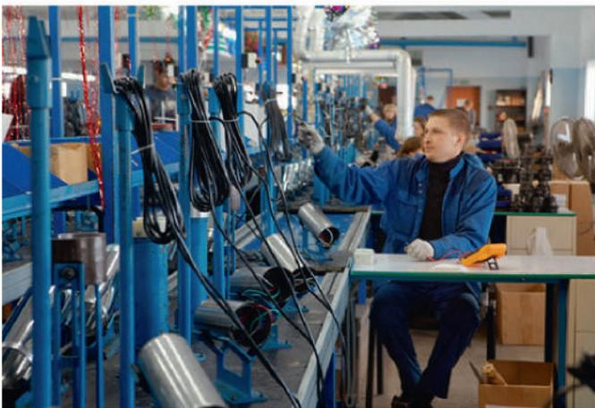
Сборочный цех приятно удивил высокой организацией процесса конвейерной сборки насосов. А после сборки каждый насос испытывается на гидравлическом стенде, что практически исключает вероятность заводского брака в отгружаемой продукции. Строжайшее соблюдение дисциплины труда и правил техники безопасности давно стали здесь нормой жизни, чем и обусловлен успех, неизменно сопутствующий компании за всю историю существования.
