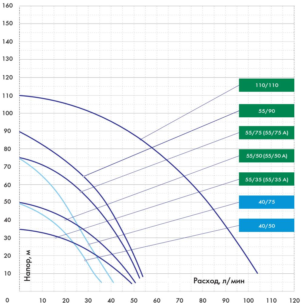
Заявленные характеристики были получены при испытании с холодной чистой водой без газа и абразивных примесей, а также напорной магистралью согласно модели насоса и напряжением 220 В.
