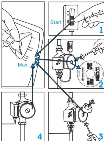
Рисунок 5. Схема выпуска воздуха
