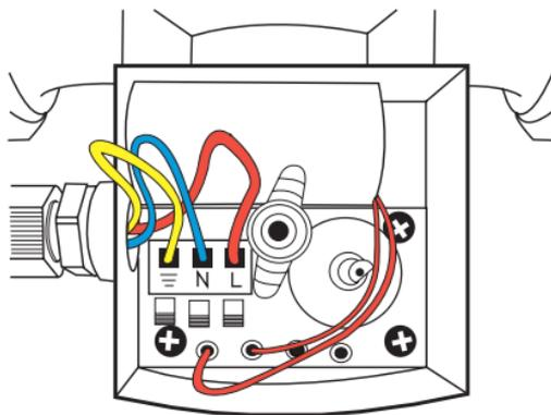
Рисунок 4. Схема электрического подключения
